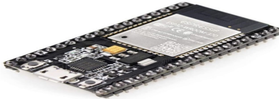
شكل رقم (2) يوضح لوحة ESP32 : شاشة LCD1602
